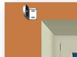
С противоположной стороны разметить и установить кронштейн. При этом кронштейны должны быть установлены строго по уровню.
